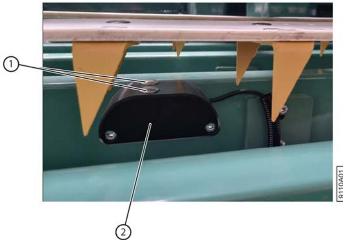
Fig. 4: Capteur d'humidité
